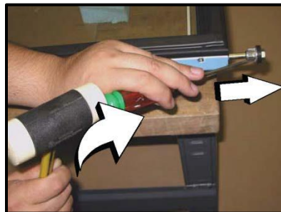
Remove Torque Rod
